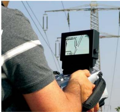
**Superb**紫外成像仪是全球紫外成像技术领导者Ofil公司与美国电力科学研究院（EPRI）共同研发的一款新型便携式紫外线成像设备，用于检测高压设备电晕、电弧和局部放电现象；SuperB采用Ofil独创的Solar Blind专利技术、全球最灵敏的日盲型紫外-可见光双通道探测器及独家镜头，设备灵敏度高，抗干扰能力强，完全不受太阳光的影响，检测时间不受限制，能在背景干扰中灵敏的探测出缺陷所发射出的微弱的紫外光，是架空输电线路和高压变电站预防性维护检测工具的理想选择。SuperB采用人体工程学设计，
