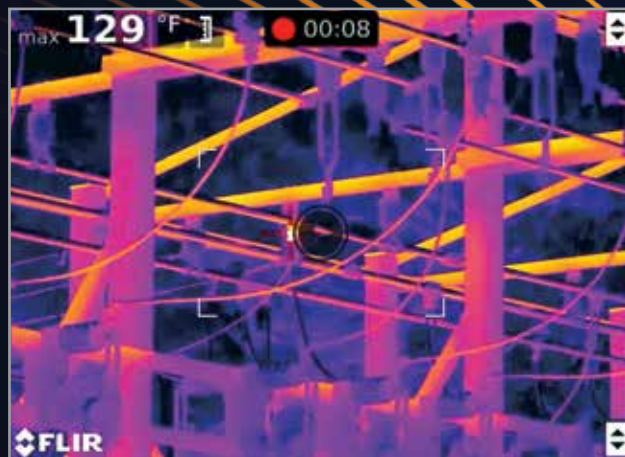
通过实时辐射视频记录整个检测过程，将FLIR T1040作为一款功能强大的便携式分析工具使用
