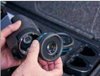
得益于AutoCal™光学部件，该热像仪可与各系列热像仪共用镜头(从广角到长焦镜头)
